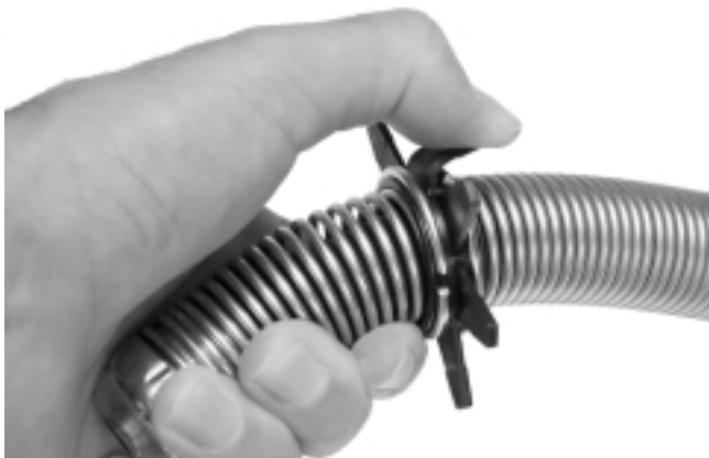
Figura 19 – Flexibilice las púas de las guías de centrado poniendo su dedo sobre la punta de cada una y luego empújelas suavemente hacia delante y hacia atrás, en casi 90 grados. Repita en el otro sentido.
