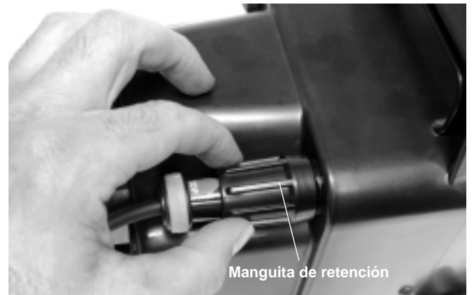
Figura 10 – Apriete la manguita de retención
