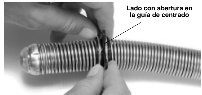
Figura 22 – Presione los aros en C contra las ranuras a cada lado de la guía de centrado. Asegure que las aberturas en las guías de centrado queden apuntando hacia el lado opuesto (en 180°) de la guía de centrado.
