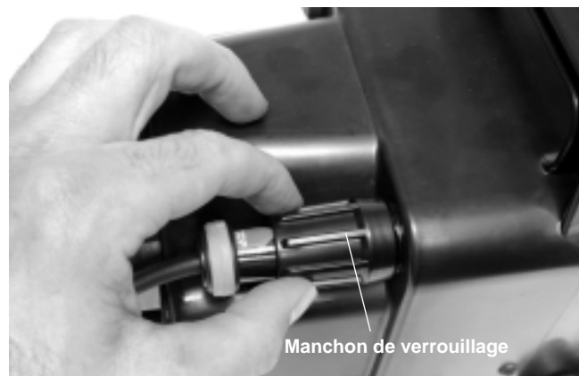
Figure 10 – Vissage du manchon de verrouillage
