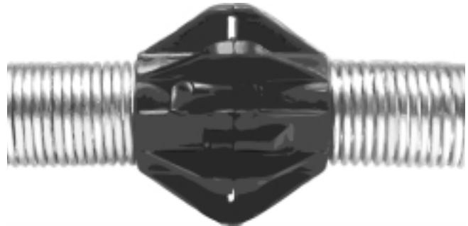
Figure 24 – Les guides de centrage améliorent la visibilité en permettant à la caméra d'assurer un balayage uniforme de toutes les parois de la canalisation, et en la maintenant surélevée par rapport aux boues du fil d'eau. Aussi réduisent-ils l'usure de la fenêtre à DEL.
