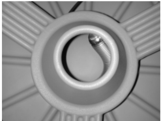
Figure 16 – Tête de caméra rangée dans le cône
