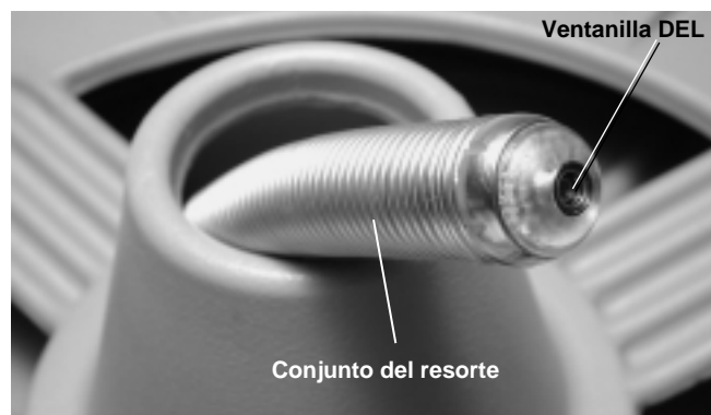
Figura 2 – Cámara en el cabezal
