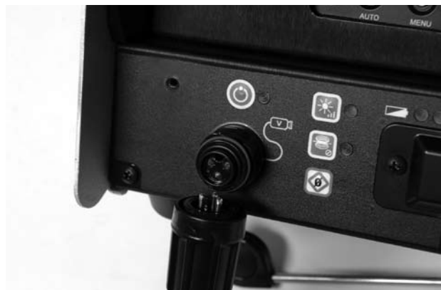
slika 8: Poravnavanje priključka kabla sustava
