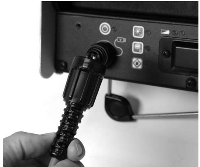
9. ábra: A rendszerdugasz csatlakoztatása a SeeSnake rendszercsatlakozóba
