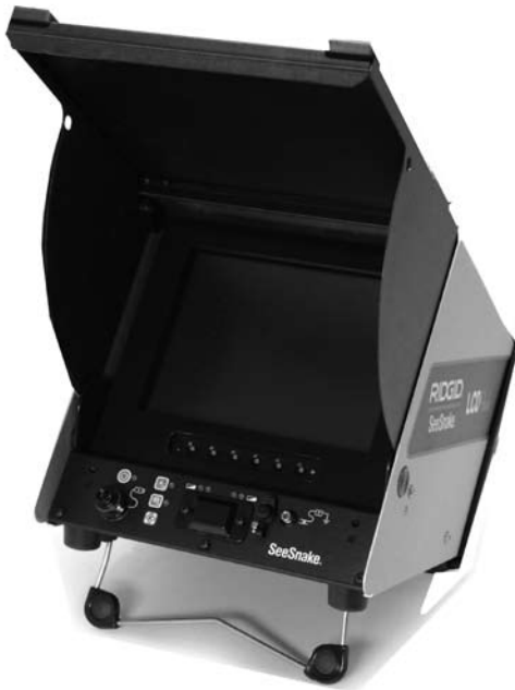
Figuur 7: LCDPak met geopende klep
