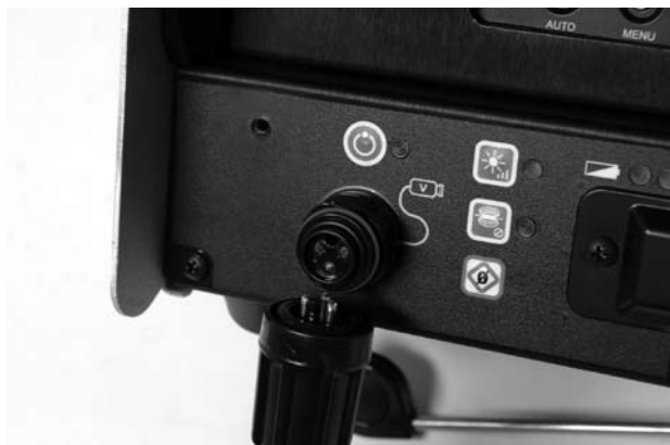
Figuur 8: De systeemkabel aansluiten
