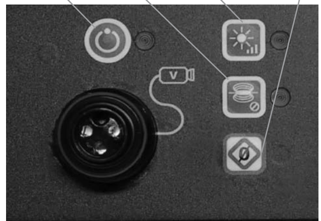
Figuur 12: Bedieningselementen van de LCDPak
