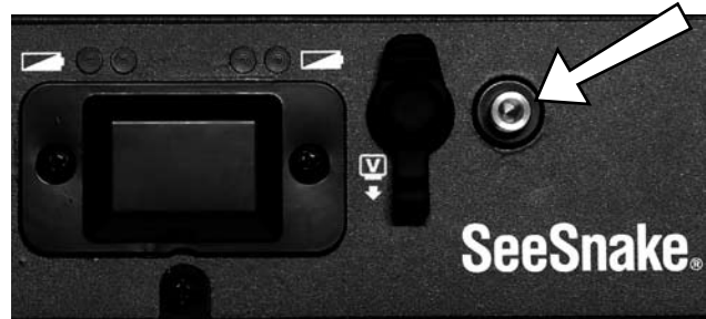
Figuur 13: Clip-on-zenderaansluiting op de LCDPak
