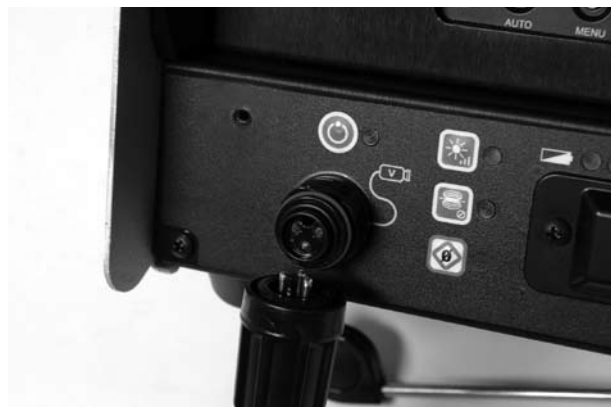
Rysunek 8: Wyrównanie wtyczki przewodu systemowego
