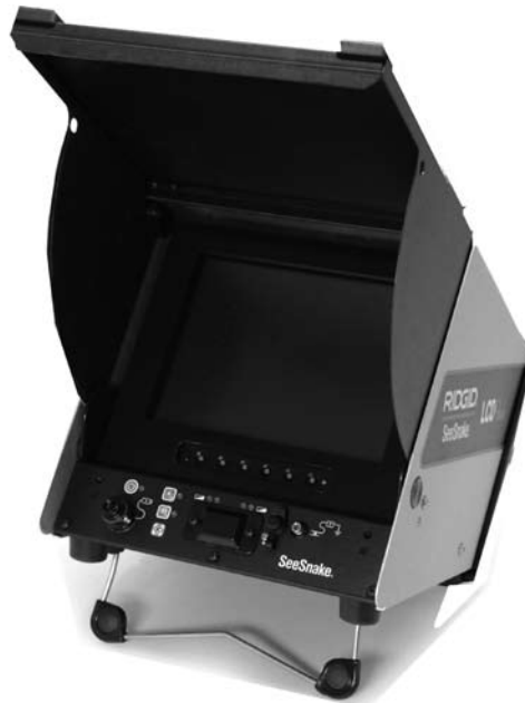
Rysunek 7: LCDPak z otwartą osłoną górną
