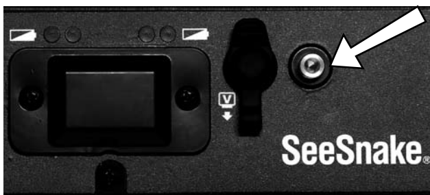
Rysunek 13: Terminal zaciskowy nadajnika LCDPak
