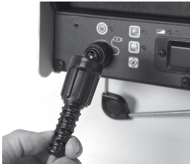
Figura 9: Ligar a ficha do sistema ao conector do sistema SeeSnake
