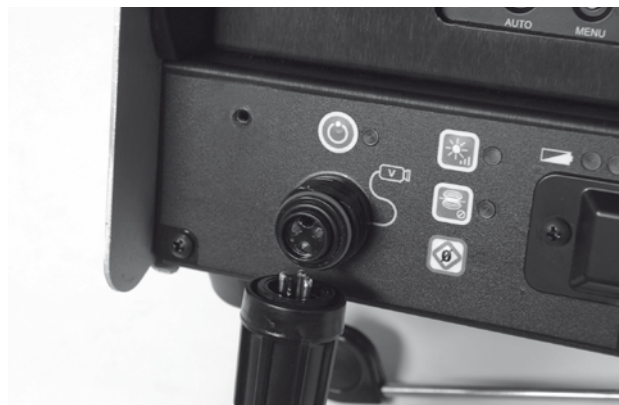
Figura 8: Alinhar a ficha do cabo do sistema
