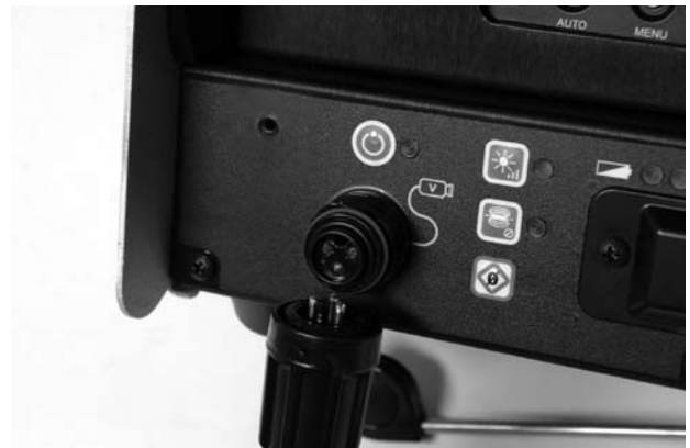
Рисунок 8. Подключение вилки системного кабеля
