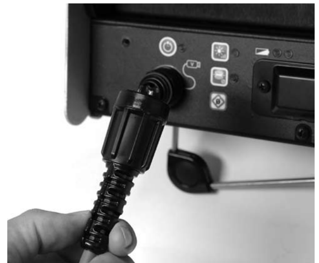
Рисунок 9: Подключение вилки системного кабеля к разъему системы SeeSnake
