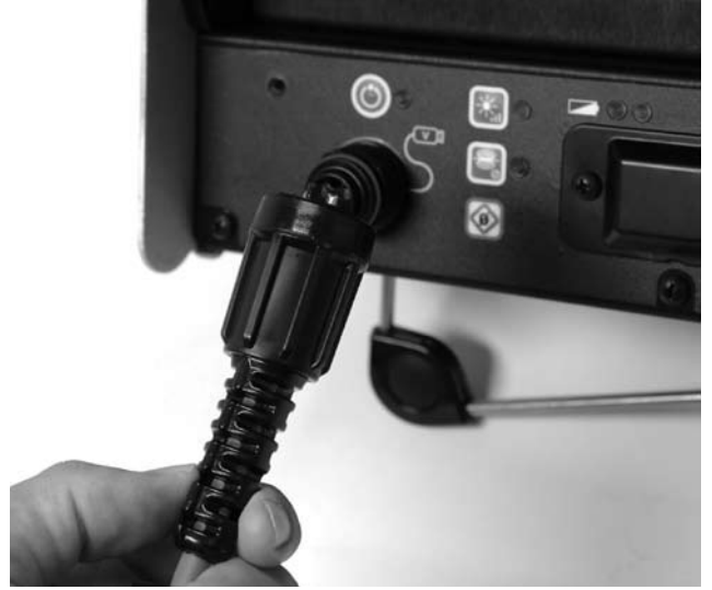
Şekil 9: Sistem Kablosu Fişi'nin SeeSnake Sistemi Bağlantı Noktası'na Bağlanması
