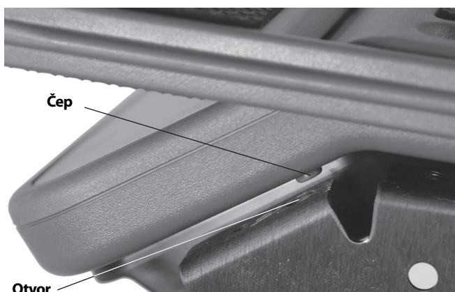
Obrázek 14 – Vyrovnání čepu a otvoru
