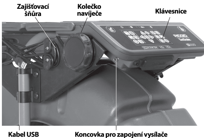
Obrázek 21 – Klávesnice, kolečko navíječe a USB kabel
