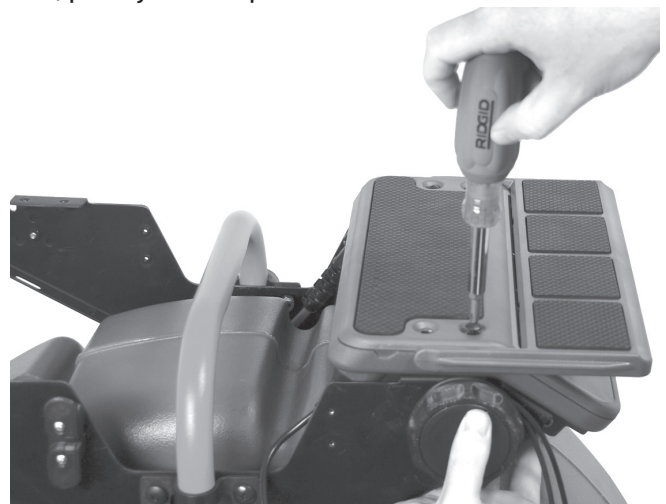
Obrázek 13 – Připevnění pravé nosné plochy
