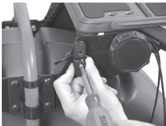
Obrázek 16 – Připevnění úchytní navinutí kabelu (Dbejte na zachycení USB kabelu pod úchytní navinutí kabelu)
