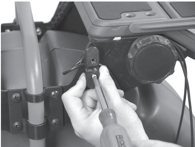
Εικόνα 16 – Στερέωση του εξαρτήματος τύλιξης καλωδίου (Προσέξτε το καλώδιο USB που παγιδεύεται κάτω από το εξάρτημα τύλιξης καλωδίου)
