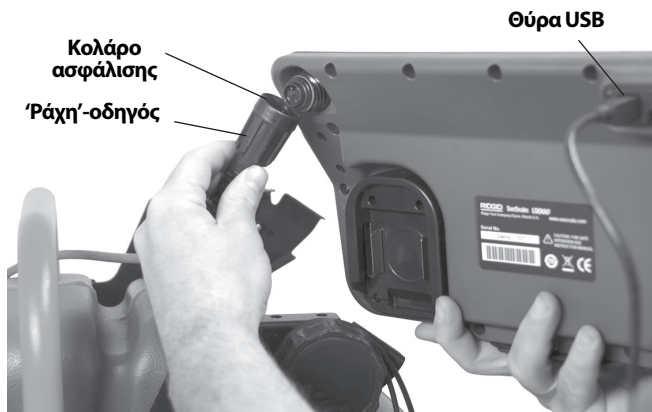
Εικόνα 12 – Σύνδεση του καλωδίου συστήματος SeeSnake
