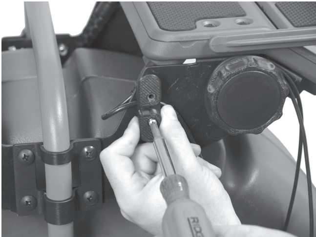
Kuva 16 – Kaapelivyhyden asennus (huomaa USB-kaapeli kaapelivyhyden alla)
