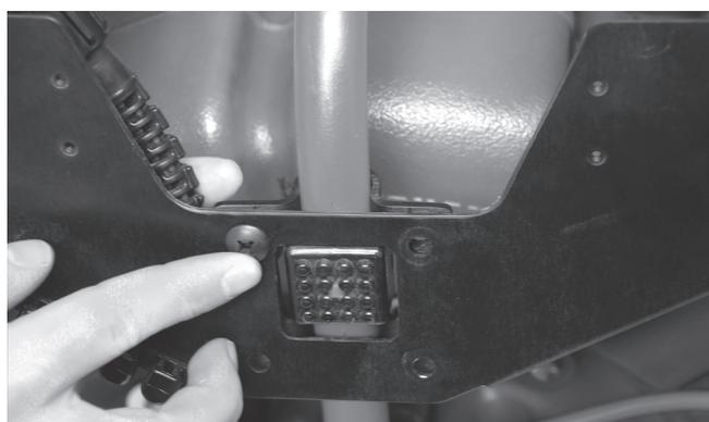
**Figure 5 – Primo bullone di fissaggio**
