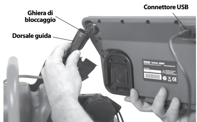
**Figure 12 – Collegamento del cavo di interconnessione SeeSnake**
