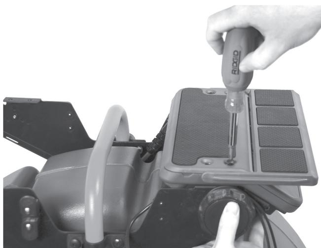
**Figura 13 – Montaggio della piattaforma destra**
