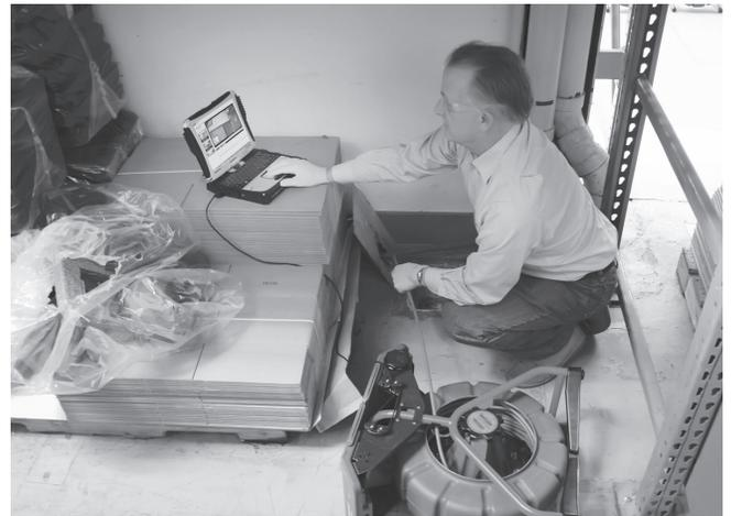
Figura 22 – Configurazione alternativa per spazi limitati
