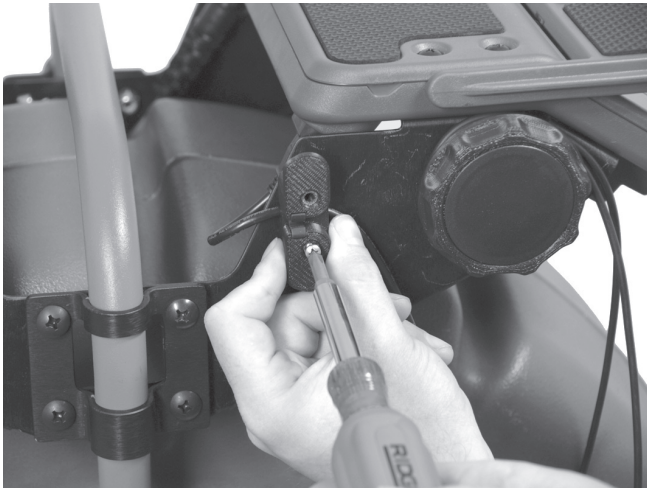
Figuur 16 – Monteren van de kabelopwikkelaarvoorziening (Noteer: USB-kabel geklemd onder kabelopwikkelaarvoorziening)
