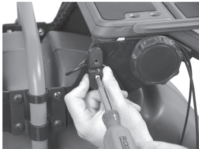
Rysunek 16 – Montaż zwijarki przewodu (Uwaga - przewód USB przechodzi pod zwijarką)
