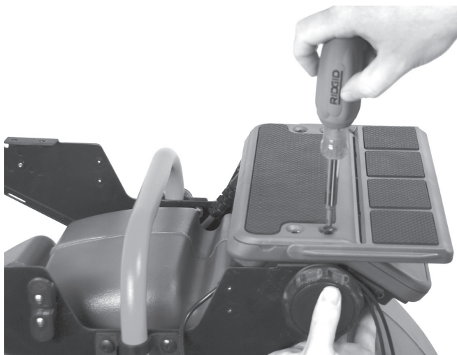
Figura 13 – Montar Plataforma Direita
