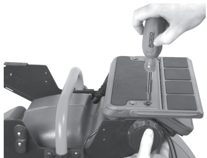
Figura 13 – Montarea platformei din dreapta
