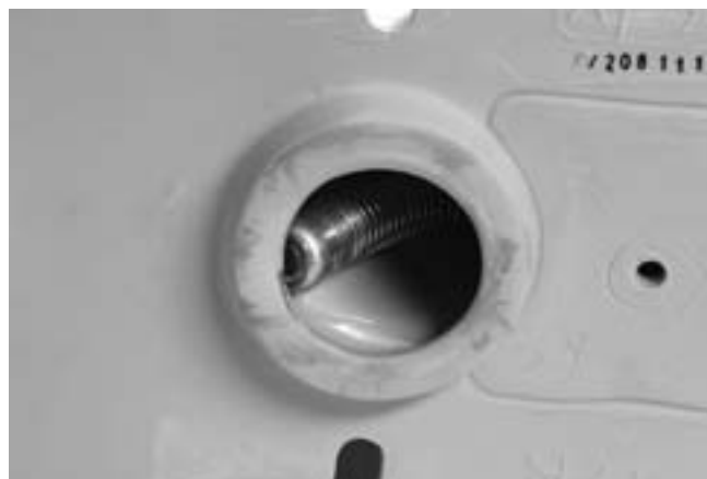
Figure 20 – Tête de caméra bloquée dans un coude
