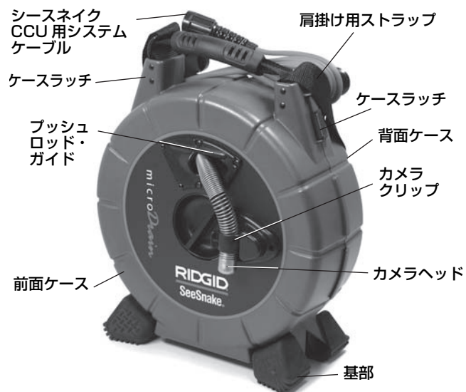
図1 - 前面 (シースネイクの構成)
