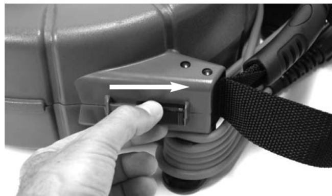
Figura 4 – Destrave a carcaça da bobina do microDrain
