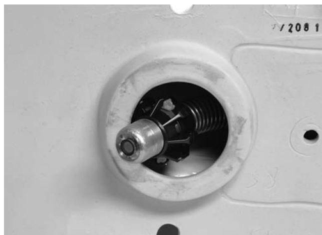
Figura 21 – Ponta da câmera com guia esférica numa curva
