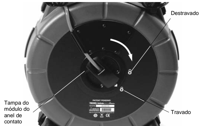
Figura 8 – Trava da tampa do módulo do anel de contato
