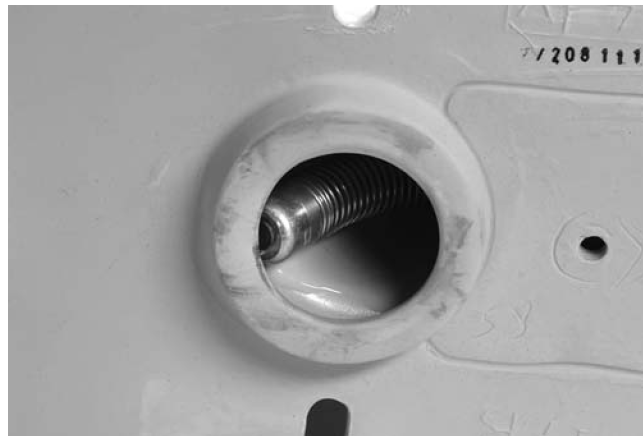
Figura 20 – Ponta da câmera bloqueada numa curva
