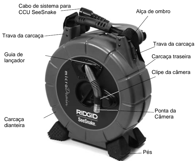
Figura 1 – Vista frontal (configuração do SeeSnake)
