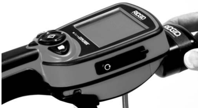
Figura 10 – Conexão do monitor da câmera microEXPLORER
