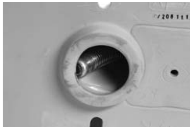
Рис. 20. Головка камеры заблокирована на повороте
