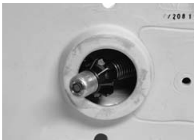
Рис. 21. Головка камеры с шариковой направляющей при прохождении поворота
