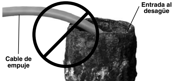
Figura 23 – Evite dañar el cable en bordes afilados
