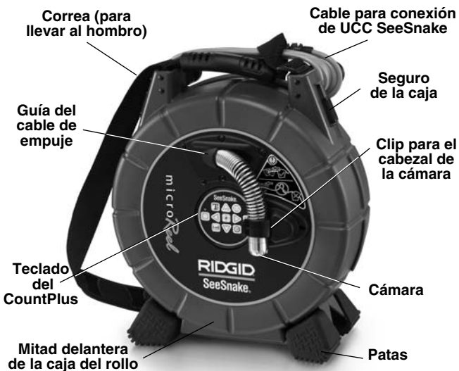
Figura 1 – Vista delantera (configuración SeeSnake)
