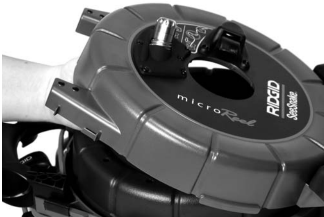
Figure 5 – Ouvrez le tambour avec précaution pour acheminer le câble
