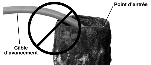
Figure 23 – Éviter d'appuyer contre le rebord
