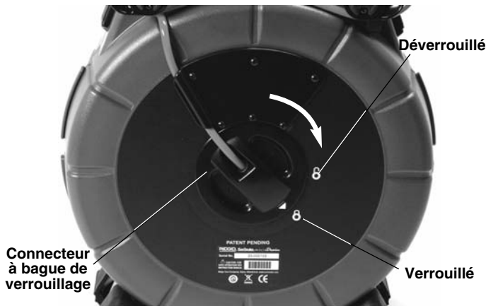
Figure 11 – Verrouillage du connecteur
