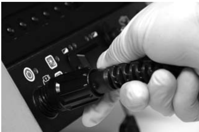
Slika 17 – Spajanje na SeeSnake CCU
