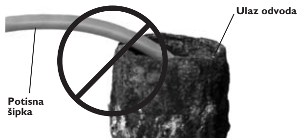
Slika 23 – Izbjegavajte povlačenje po oštrim rubovima
