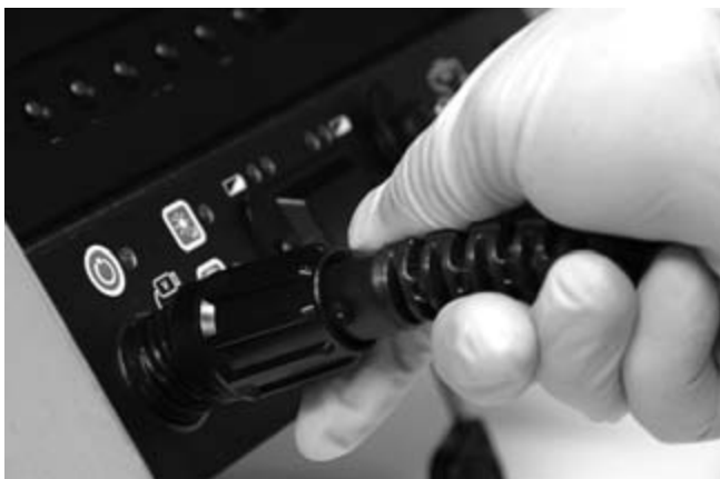
17. ábra – Csatlakoztatás a SeeSnake CCU egységéhez
