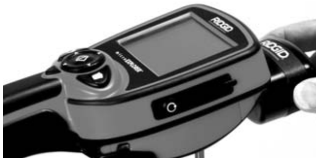
14. ábra – A microEXPLORER kameramonitor csatlakoztatása
