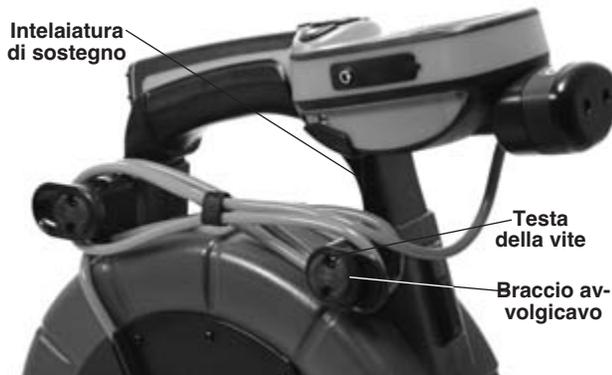
Figura 13 – Intelaiatura di sostegno e bracci avvolgicavo
