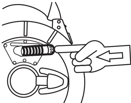
**Figura 8 – ACCERTARSI CHE LA TELECAMERA SIA COMPLETAMENTE ALL'INTERNO DEL TAMBURO PRIMA DI SBLOCCARE I GANCI E DI APRIRE L'ALLOGGIAMENTO. Sarà così possibile ridurre il rischio di fuoriuscita improvvisa e di attorcigliamento del cavo.**
