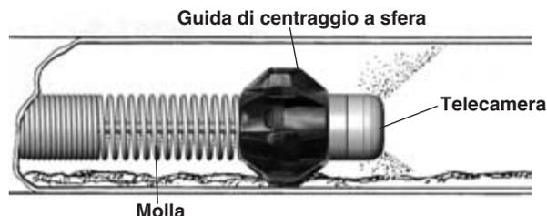
Figura 16 – Guide di centraggio a sfera in uso
