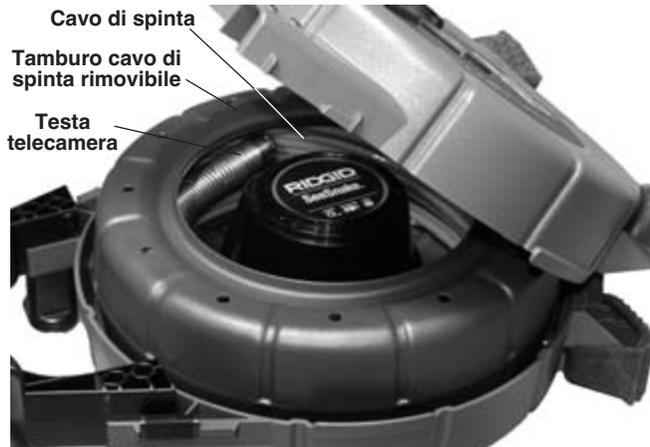
Figura 3 – Apertura dell'alloggiamento
