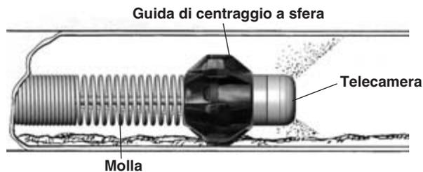
Figura 24 – Guide di centraggio a sfera in uso
