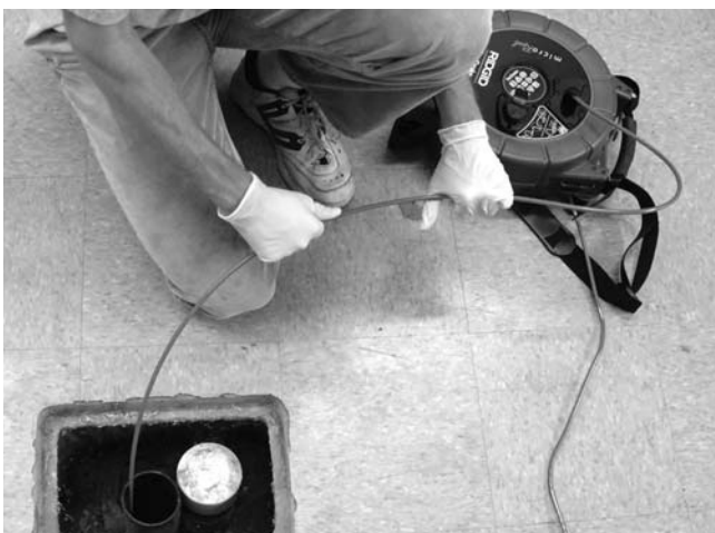
図 29 — ねじれる危険があるので、ドラム収納時にケーブルをたるませない
