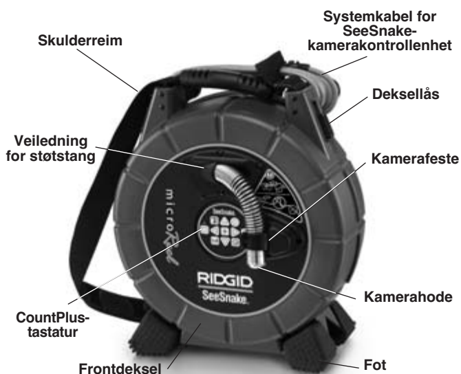
Figur 1 – Frontvisning (SeeSnake-konfigurasjon)
