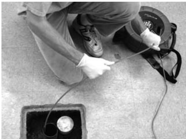
Figur 28 – Korrekt teknikk for skyving av kabelen tilbake i trommelen
