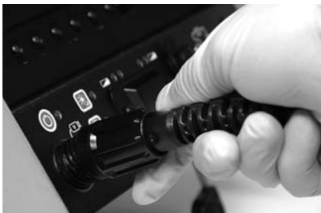
Figur 17 – Koble til en SeeSnake-kamerakontrollenhet
