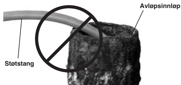
Figur 23 – Unngå å trekke den over skarpe kanter
