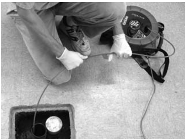
Slika 29 – Če pustite, da se kabel zvije, lahko pride med potiskanjem v bobna do prepogibanja kabla
