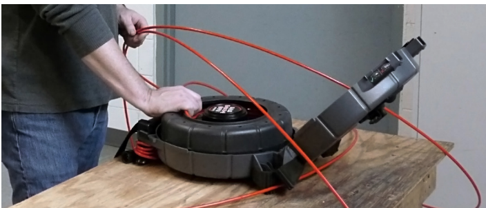
Abbildung 1 – Richtiges Einsetzen der Trommel im Gehäuse
