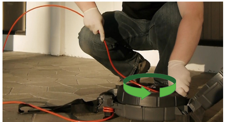
Figura 4 – Come guidare il cavo di spinta dentro il tamburo
