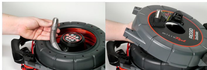
Rysunek 5 – Wyciąganie głowicy kamery przez przewodnicę przewodu
