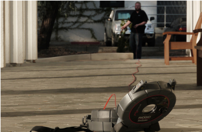
Şekil 2 – İtme kablosunu düzleme
