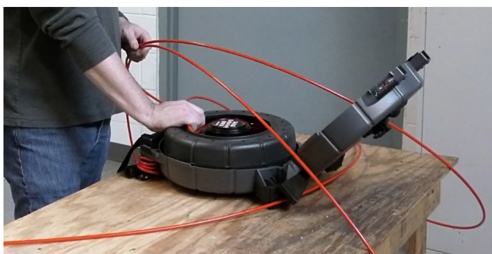
Figura 1 – Tambur corect introdus în carcasă
