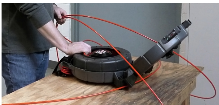
Figur 1 – Tromle korrekt placeret i kasse
