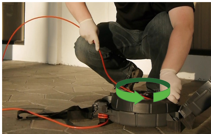
Figure 4 – Guidage du câble de poussée dans le tambour
