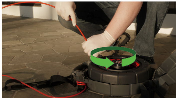
Рисунок 3 – Вращайте барабан, чтобы правильно намотать проталкивающий кабель
