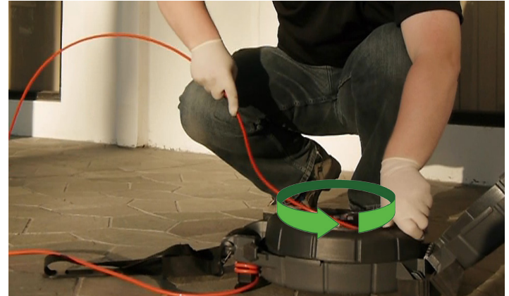
Şekil 4 – İtme kablosunun tambura sokulması
