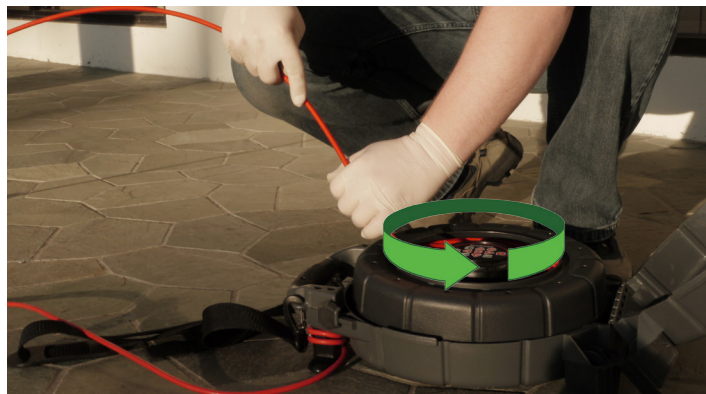
Obrázek 3 – Otáčení bubnu pro správné navinutí vodícího kabelu
