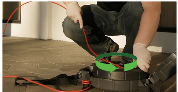
Abbildung 4 – Einführen des Schubkabels in die Trommel
