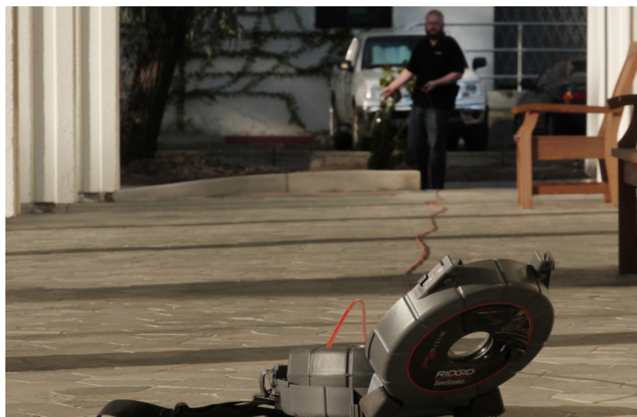
Bild 2 – Rätta ut tryckstängan
