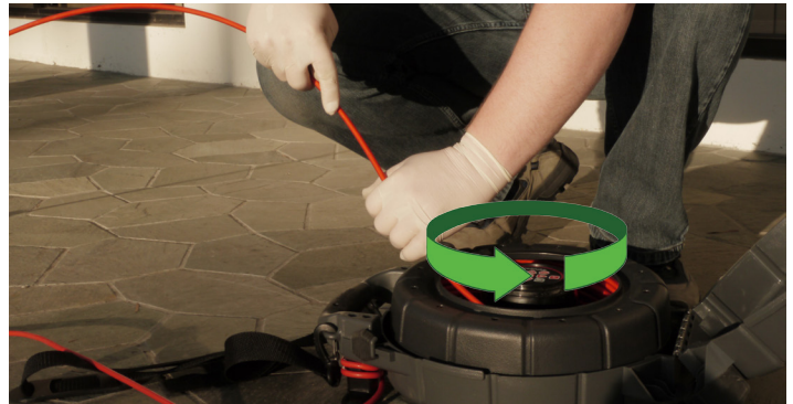
Figura 3 – Girando el cilindro para enrollar apropiadamente el cable de empuje
