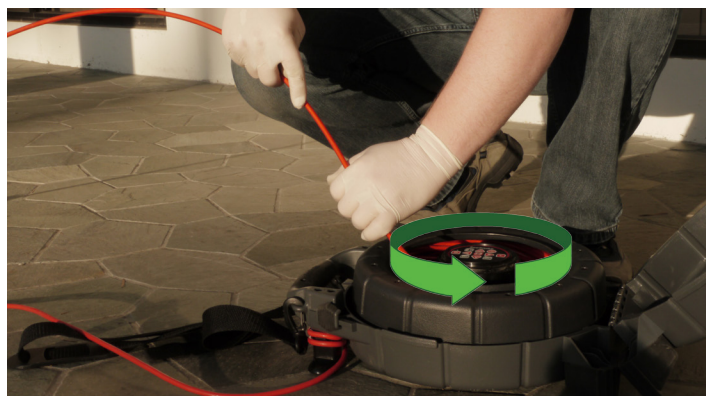
Figur 3 – Roter trommelen for å ordentlig spole push-kabelen
