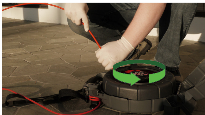
Rysunek 3 – Obracanie bębna w celu prawidłowego przewijania przewodu popychacza
