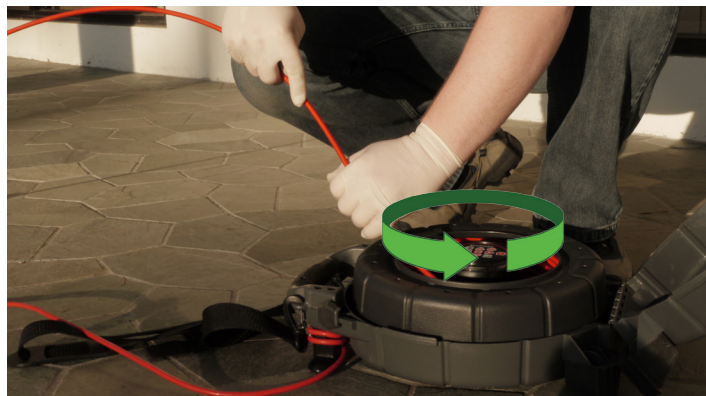
Figura 3 – Girando o tambor para enrolar corretamente o cabo de tração
