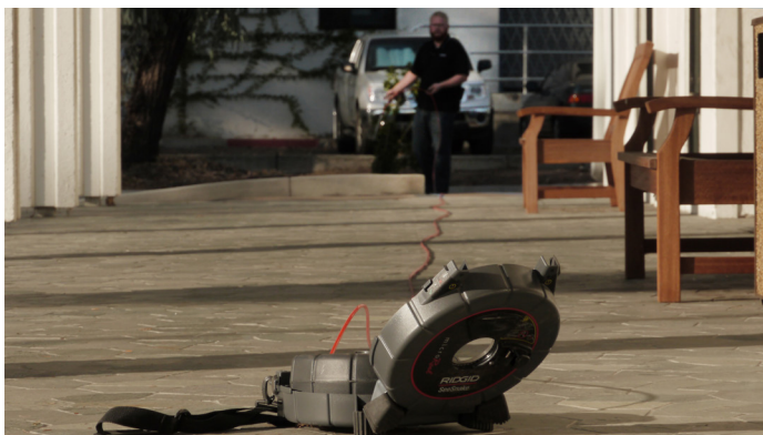
Afbeelding 2 – De duwkabel rechtmaken
