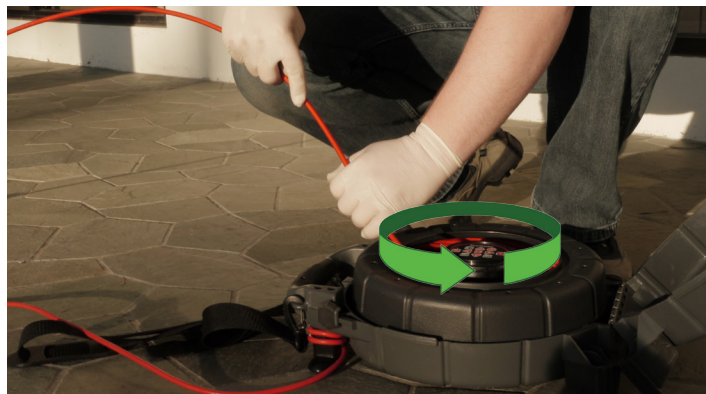
Bild 3 – Roter trumman för att rulla in tryckstängan riktigt
