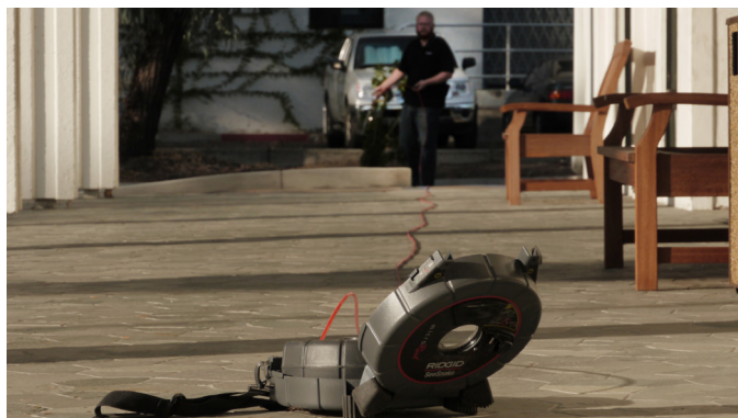
Figura 2 – Întinderea cablului împingător
