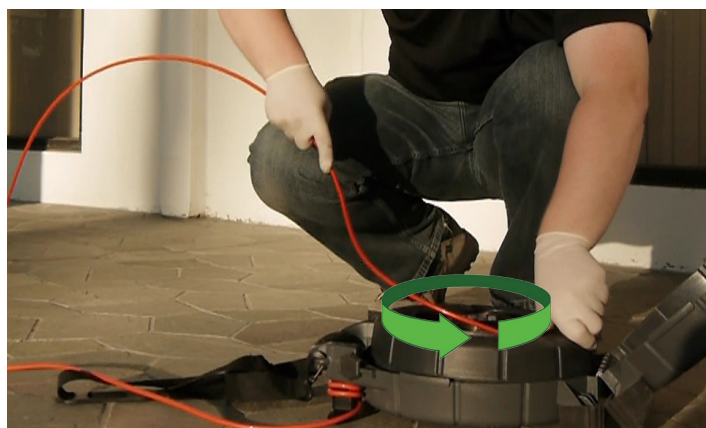
Obrázok 4 – Namotanie tlačného kábla do bubna
