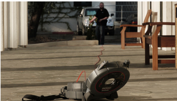
Abbildung 2 – Geradebiegen des Schubkabels
