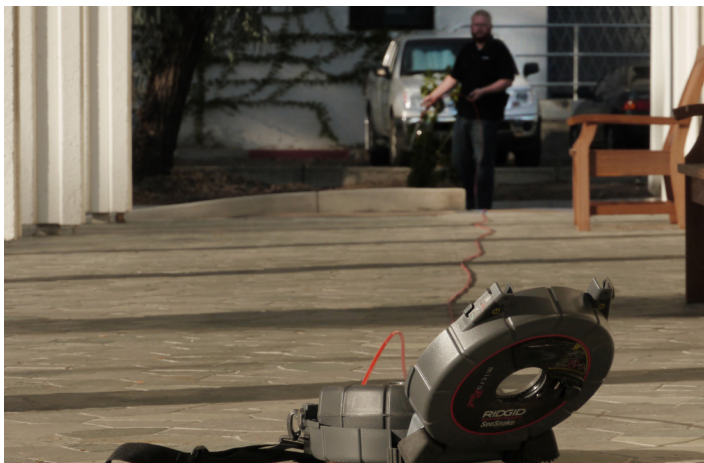
Sliku 2 – Ispravljanje kabela za pritiskanje
