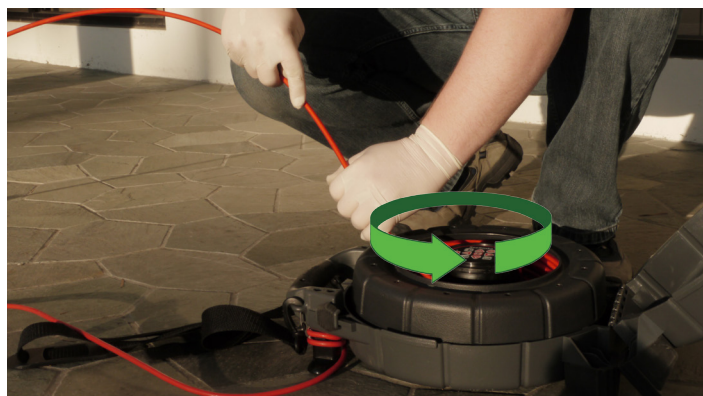
Figur 3 – Rotering af tromlen for at vikles skubbekablet korrekt
