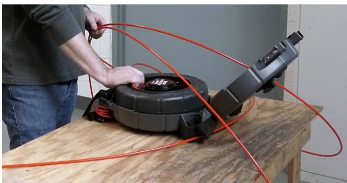
Figur 1 – Trommelen korrekt satt i beholderen
