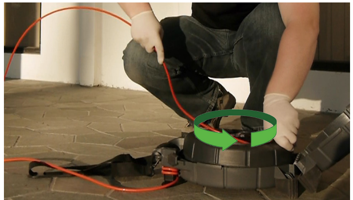
Figura 4 – Guiando el cable de empuje hacia el cilindro
