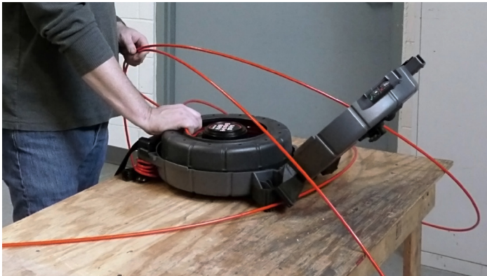
Figura 1 – Cilindro colocado apropiadamente en el estuche
