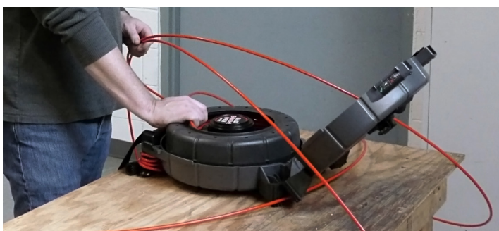
Rysunek 1 – Bęben poprawnie umieszczony w obudowie
