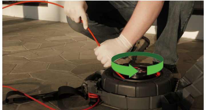
Afbeelding 3 – De haspel draaien om de duwkabel op de juiste manier op te winden
