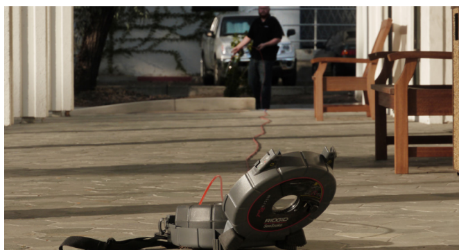
Rysunek 2 – Prostowanie przewodu popychacza
