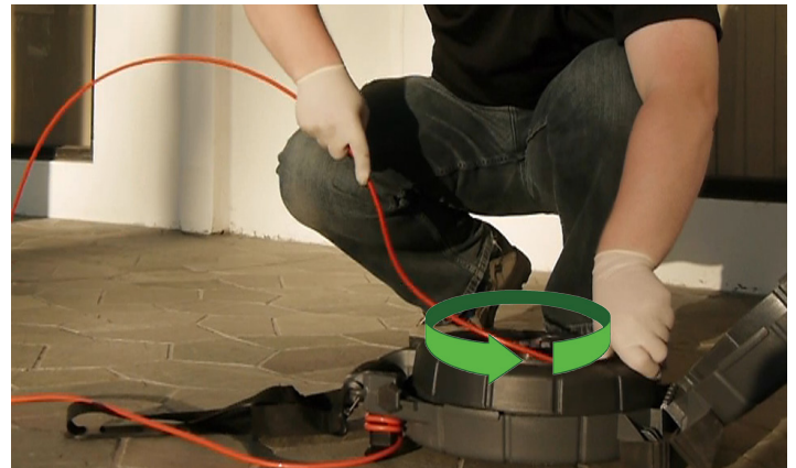
Kuva 4 – Työntökaapelin ohjaaminen haspeliin
