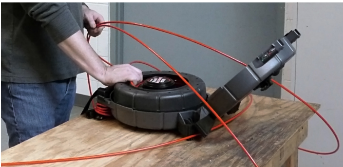
Figura 1 – Tamburo alloggiato correttamente nella custodia
