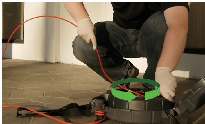
Bild 4 – Vägleda tryckstängan in i trumman
