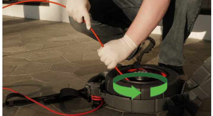
Ábra 3 – A tekercs forgatása a toló-kábel helyes feltekerésére
