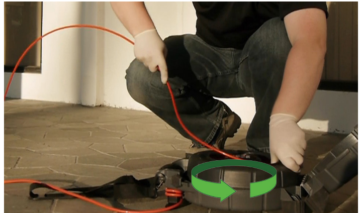
Ábra 4 – A toló-kábel feltekerése a tekercsre
