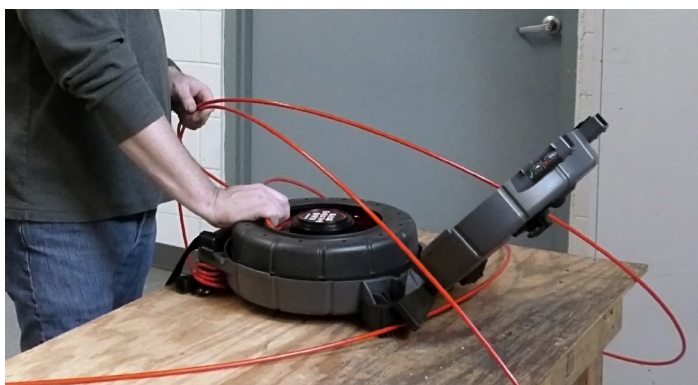
Figure 1 – Tambour correctement installé dans le boîtier
