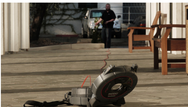
Εικόνα 2 – Ισιώνοντας το καλώδιο προώθησης
