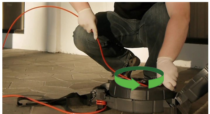
Εικόνα 4 – Καθοδηγώντας το καλώδιο προώθησης μέσα στο τύμπανο
