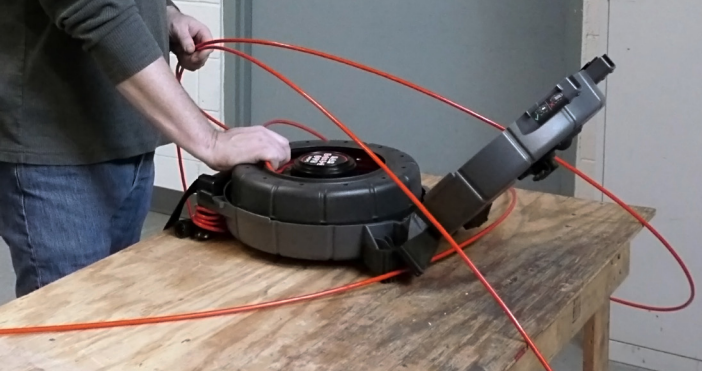
Şekil 1 – Tambur tam olarak kutunun içine oturuyor
