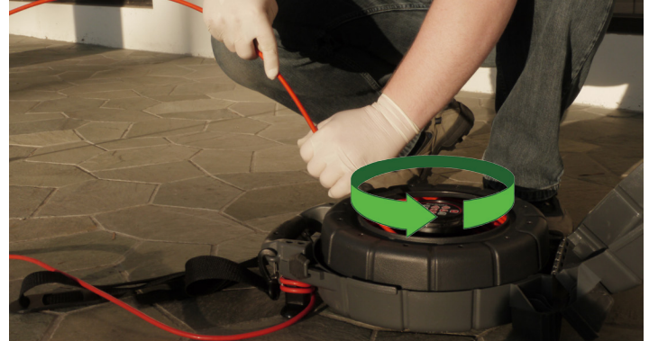
Abbildung 3 – Drehen der Trommel um das Schubkabel korrekt ab- und aufzuspulen
