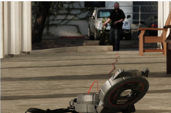
Figura 2 – Estiramiento del cable de empuje
