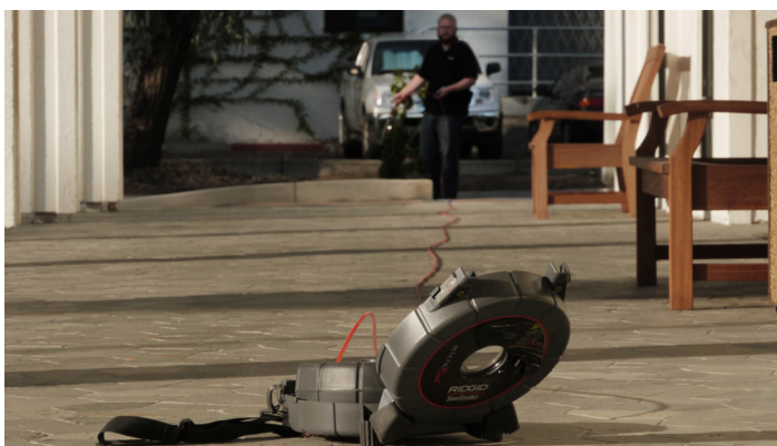
Figure 2 – Redressement du câble de poussée
