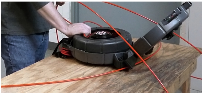
Εικόνα 1 – Το τύμπανο σωστά τοποθετημένο στην υποδοχή
