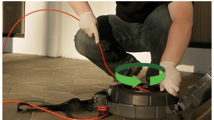
Sliku 4 – Navođenje kabela za pritiskanje u bubanj
