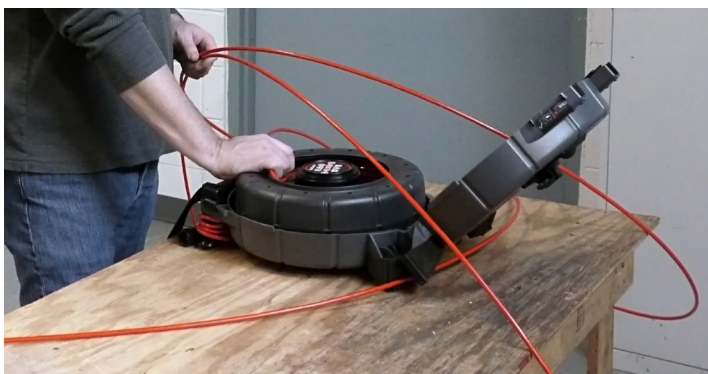
Slika 1 – Pravilno vstavljen boben v ohišje
