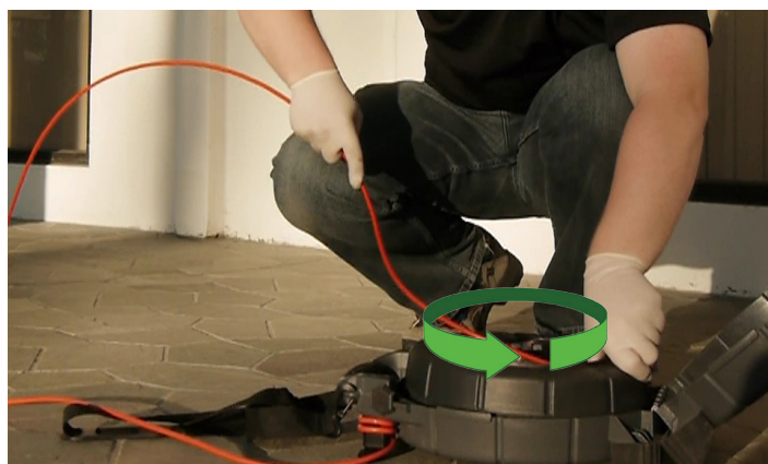
Figur 4 – At føre skubbekablet ind i tromlen
