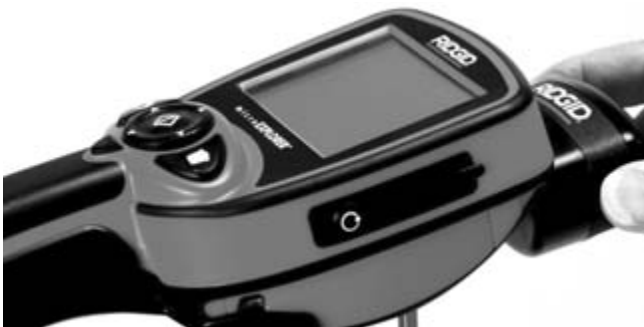
Slika 14 – Priključivanje microEXPLORER monitora kamere
