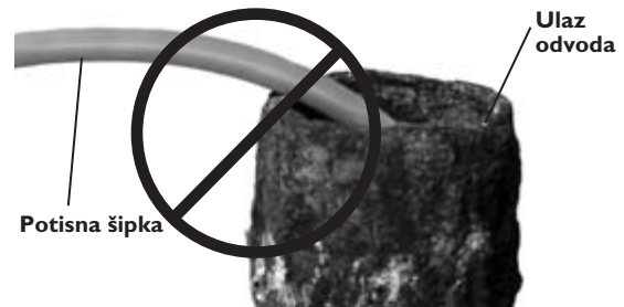
Slika 23 – Izbegavajte povlačenje po oštrim ivicama
