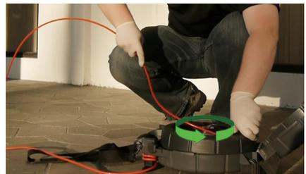
5. Führen Sie den Kamerakopf behutsam durch die Führung des Schiebekabels.
