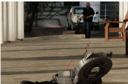
3. Beginnen Sie mit beiden Händen, das Schubkabel in die Trommel zurückzurollen. Wenn sich das Schubkabel nicht gerade auslegen lässt, müssen Sie beim Aufwickeln des Schubkabels äußerst vorsichtig vorgehen. Achten Sie darauf, dass das Schubkabel nicht
