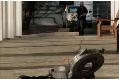
3. Con ambas manos, comience a rebobinar el cable de empuje en el tambor. Si el cable de empuje no puede colocarse recto, tenga mucho cuidado al rebobinarlo. Asegúrese de que el cable de empuje no se doble ni quede atrapado debajo o dentro de algún objeto.
