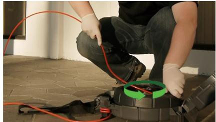
5. Pase con cuidado el cabezal de la cámara por la guía del cable de empuje.
