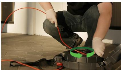
5. Аккуратно проденьте головку камеры через направляющее отверстие для проталкиваемого кабеля.
