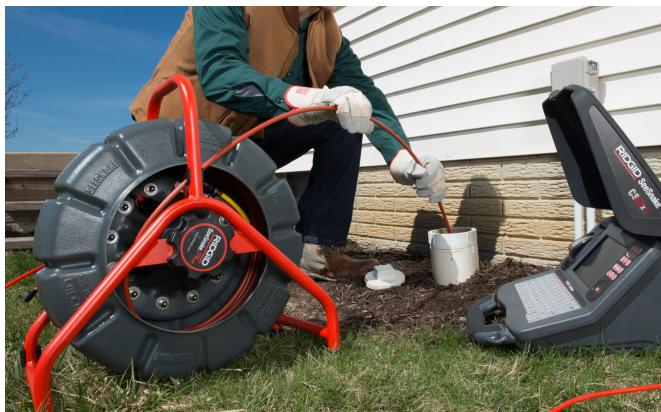
Položite SeeSnake na naličje radi veće stabilnosti, posebno kada ste na krovu, nadzemnom ulazu ili padini.
