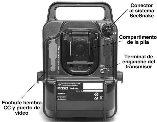
Figura 6 – Conexiones del MINIPak
