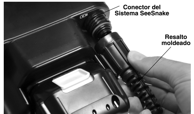
Figura 7 – Conexión del enchufe del sistema SeeSnake al conector correspondiente en el MINIPak
