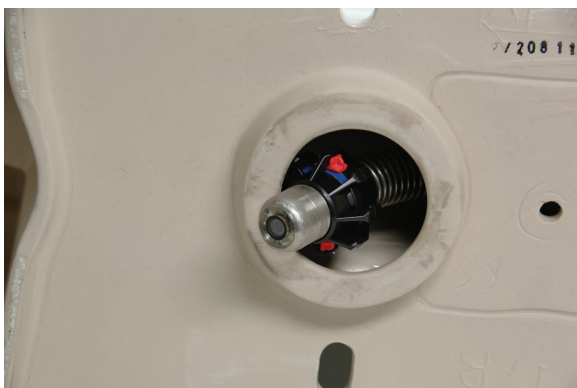
Abbildung 17 – Kamerakopf mit Kugelführung in Biegung
