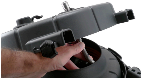
Abbildung 5 – Verlegung des Kamerakopfes
