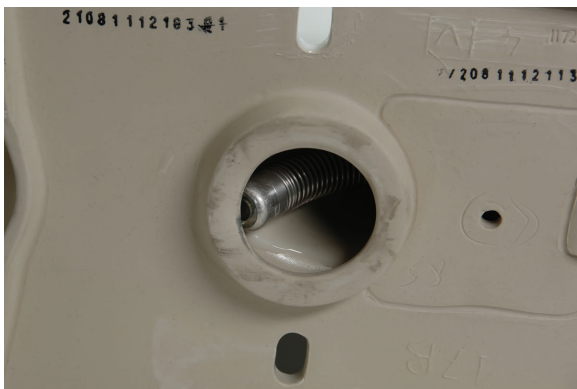
Abbildung 16 – Kamerakopf in Biegung blockiert
