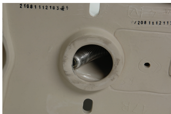
Figura 16 – Cabezal de la cámara bloqueada en una curva
