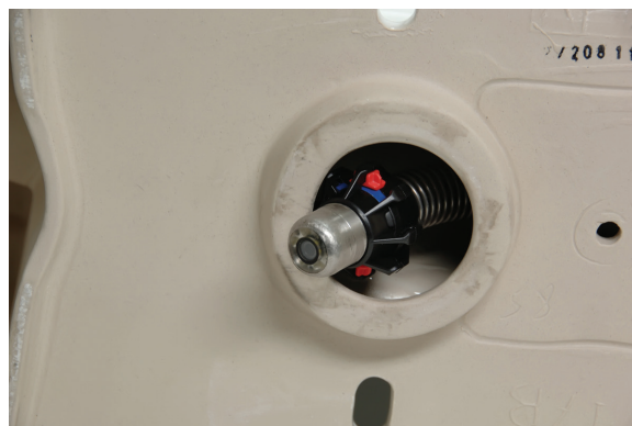
Figura 17 – Cabezal de la cámara con guía de bola en una curva
