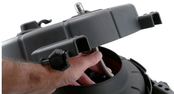
Figure 5 – Passage de la tête de caméra
