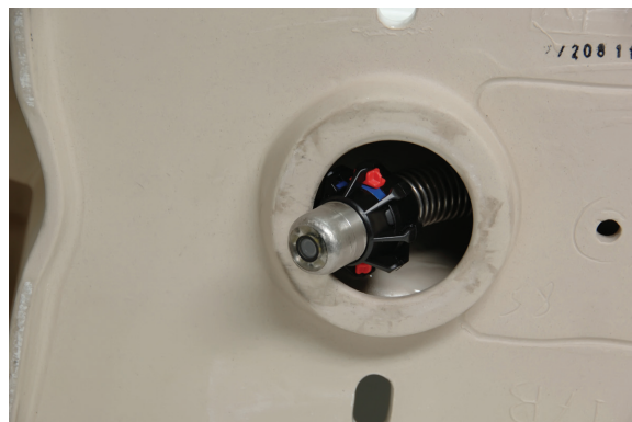
Figure 17 – Tête de caméra avec bague de guidage à billes dans une courbe
