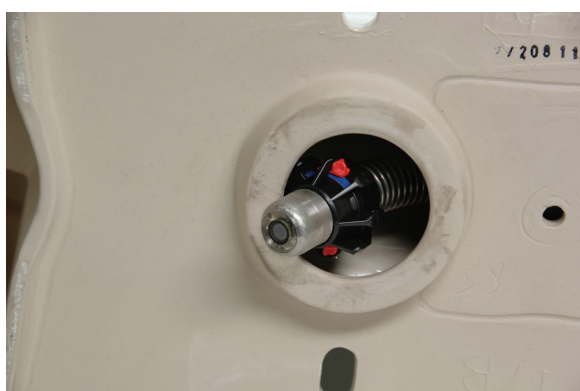
Figura 17 – Testa della telecamera con guida di controllo a sfera nella curva
