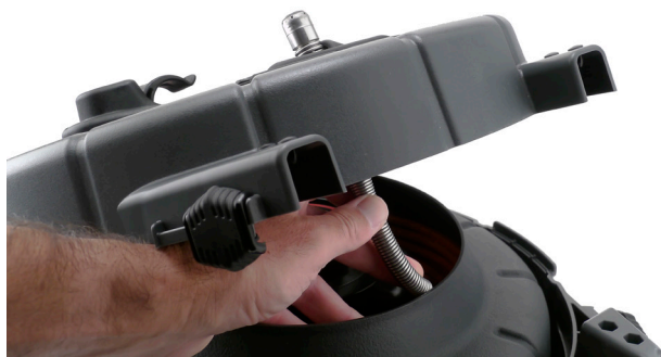
Figura 5 – Sistemazione della testa della telecamera
