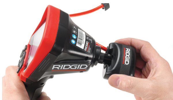
Figura 9 – Collegamento della telecamera micro CA-300
