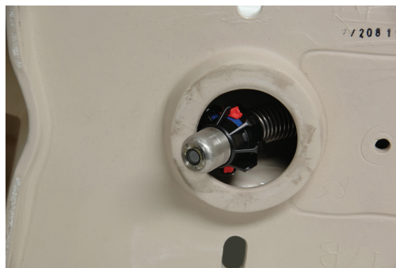
図 17 - 曲げ部分のボールガイド付きカメラヘッド
