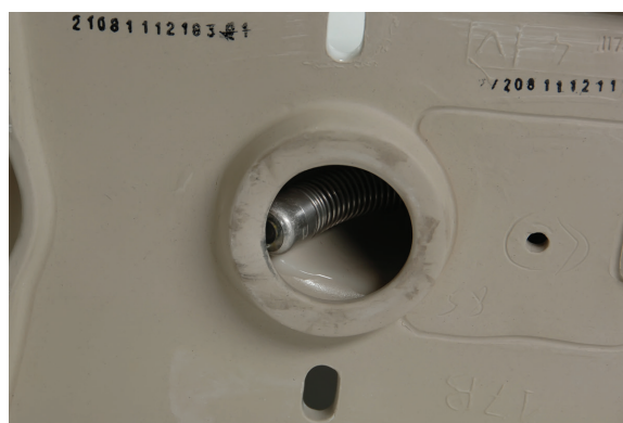
図 16 - 曲げ部分でブロックされたカメラヘッド
