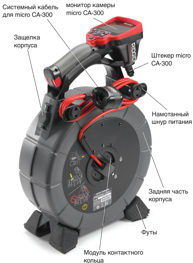
Рисунок 3 – Вид сзади (Схема micro CA-300)
