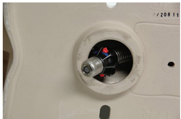
图17 ~ 带球形导向的摄像头位于弯道处
