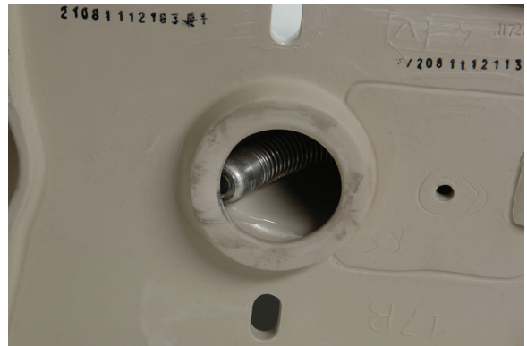
图16 ~ 摄像头在转弯处堵塞
