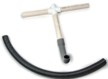
Use um cano de PVC e conduíte para formar um tubo de guia com um tubo de acesso curvo no fundo do guia para guiar o cabo de tração para além da porcelana sem causar danos.
