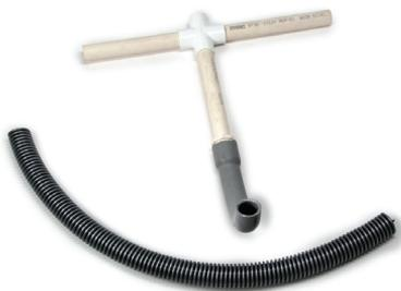
Используйте ПВХ и изоляционные трубы, чтобы сделать направляющую в виде изогнутой трубки для получения доступа к дну, чтобы направлять проталкиваемый кабель вдоль фарфоровой поверхности, не повреждая ее.
