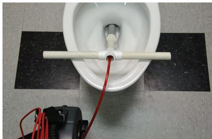
Используйте рифленую гибкую изоляционную трубу, чтобы создать гибкую направляющую трубку подобную направляющей трубке из ПВХ
