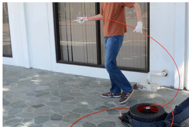
図 17 - ケースに適切に配置されたドラム
