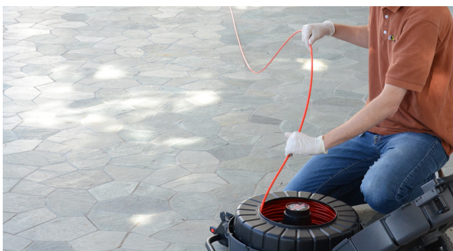
図 18 - プッシュケーブルを正しく巻き戻すためにドラムを回転させる
