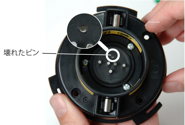
図 4 - 壊れた接続ピン
