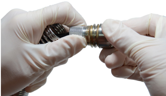
図 15 - カメラヘッドの取り外し
