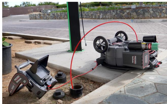
Используйте транспортировочную ручку в качестве откидной ножки при выполнении видеодиагностики на крыше, на уклоне, или в местах, где требуется верхний ввод кабеля.
