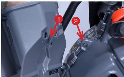
3. Ziehen Sie die vorderen und hinteren Haken in die nächstgelegene Nut am rM200 Gehäuse und lassen Sie sie einrasten, um den Aufbewahrungsbehälter sicher zu befestigen.
