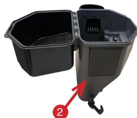
2. Installare il supporto latta sull'altra parte dello scomparto di stivaggio e avvitare la piastra di ricambio al suo posto.
