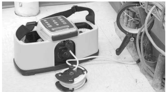
Figure 12 – Pince à induction autour du conducteur
