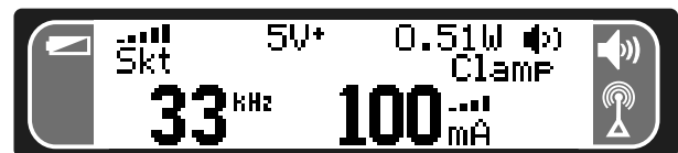
Figure 11 – Transmetteur en mode « induction »
