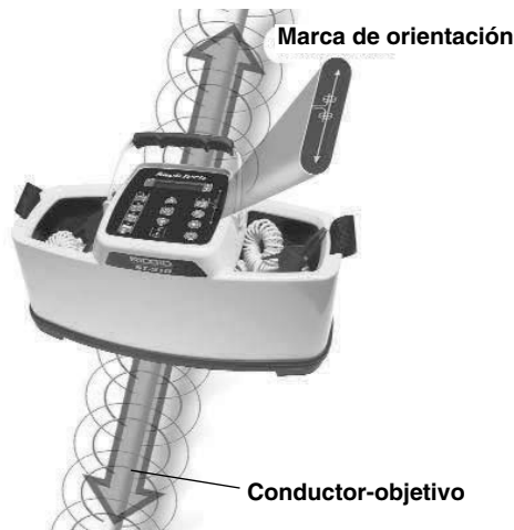
Figura 13 – Cómo debe orientarse el transmisor con relación al conducto cuando en Modalidad Inductiva
