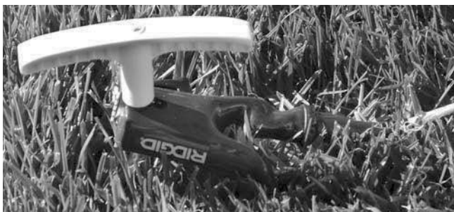
Figure 7 – Raccordement d'un des câbles au piquet de terre
